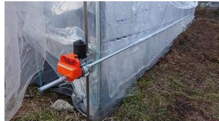
ビニールハウス窓部の開閉器（制御機器）
