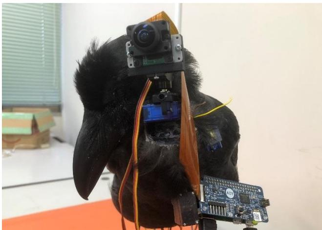
カラス3Dモデルの製作・動作検証
