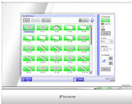
■ 運転/停止や温度・風量の設定の他、セットバックや設定温度シフト、予冷予熱制御といった多彩な制御機能も設定可能。
